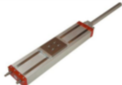
LK100 - Unité Linéaire Course 500 mm Piston 154 N à 5 bars Charge 750 N Double rail / Rattrapage de jeu
